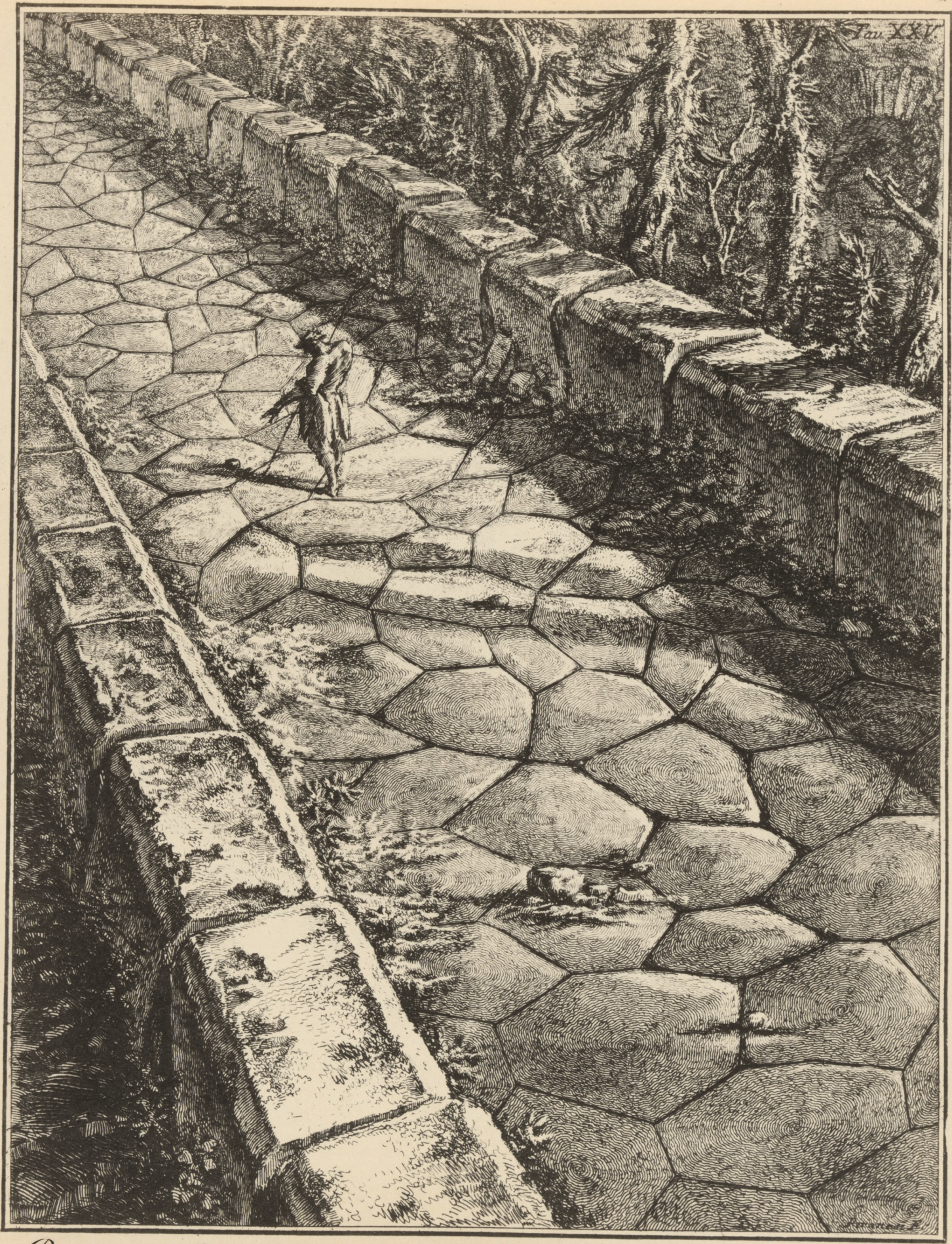
Prospetto del Lastricato e de' margini dell' antica via Appia, delineato così come si vede verso Roma poco più in quà della città d'Albano.
