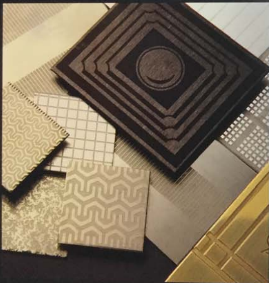
Images transformed from film onto metals through acid etching. Blue patina - chrome oxide. Images transformées de la pellicule au métal, au moyen de la gravure à l'acide. Patine bleue - oxyde de chrome.
